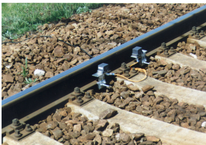
Obr. 2: Kolejová čidla vjezdového detektoru upevněná ke kolejnici
