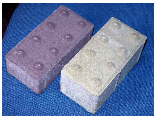
Obr. 8: Materiál pro hmatové úpravy, betonová zámková dlažba s půlkulovitými výstupky
