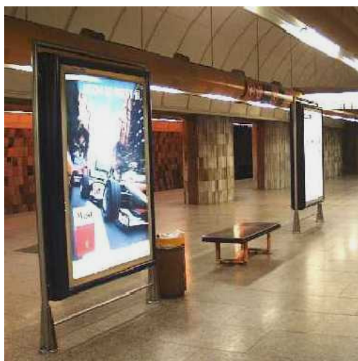
Obr. 9: Stojany informačního systému, vlevo správné řešení se zarážkou pro slepeckou hůl
