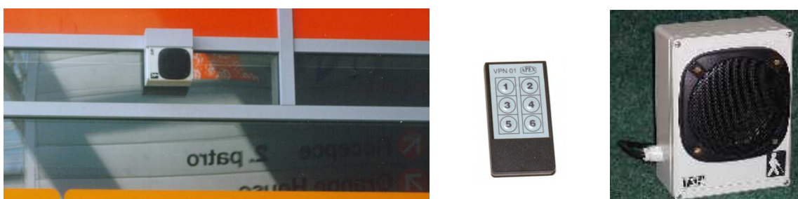
Obr. 3: Dálkově ovládaný digitální majáček s hlasovou frází, umístění, detail
