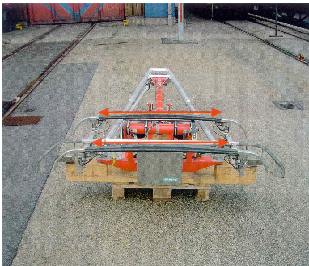
Umístění měřicích snímačů přítláčné síly na sběrači WBL 85 pro CDT 680
