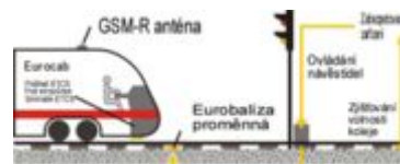
Schéma funkce ETCS L1
