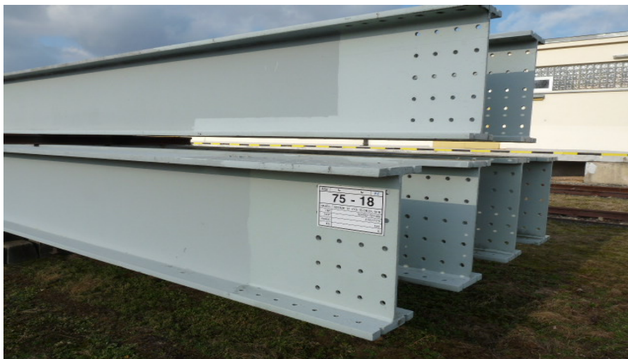
Obr. 3: Úložiště PZ Chrast u Chrudimi – uložení nosníků IP 75 – 18.
