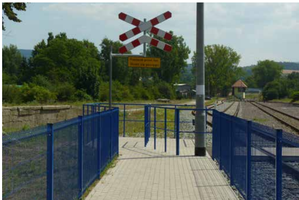
Foto5 – V žst. Kudowa Zdrój byla při rekonstrukci uplatněná „šikana“ před vstupem na centrální přechod a zabezpečení přechodu výstražným křížem stejně jako na žel. přejezdech
