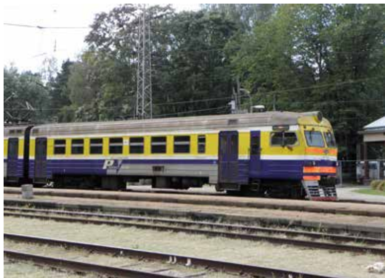
Obr. 3: Současné elektrické jednotky v soustavě 3 kV ss
